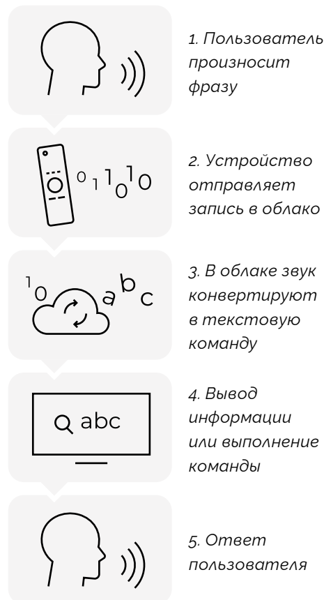
▲ Упрощенная схема распознавания голосовых команд
